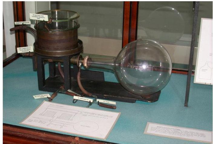
Première chambre à brouillard créée par Wilson
