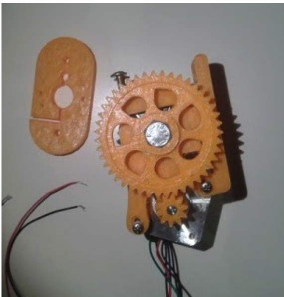
Illustration 7: Mécanisme pas à pas permettant de faire avancer le fil vers l'extruder, fabriqué sur notre demande par une société spécialisée dans ce genre de réalisations.
