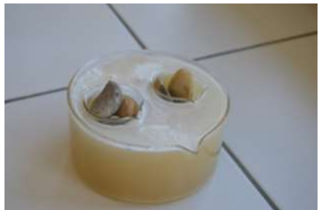
Fig 17 : solidification du gel d'agar-agar saturé en chlorure de sodium
