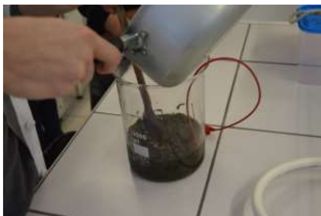
Fig 8 : coulage du pont salin
