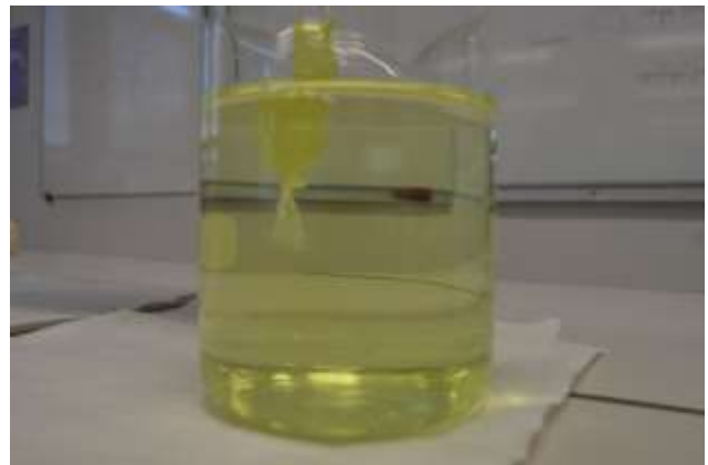
Fig 4 : la solution aqueuse d'hexacyanoferrate (III) de potassium a migré à travers la membrane
