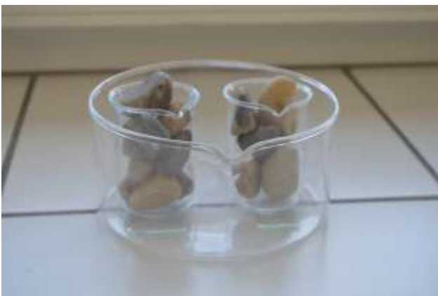
Fig 16 : préparation des deux demi-piles
