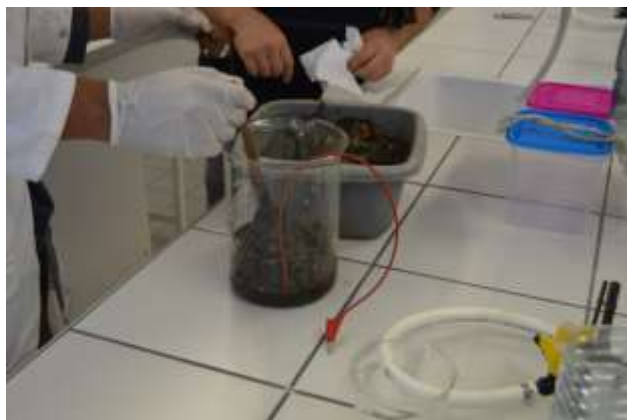
Fig 6 : remplissage du fond du bécher avec de la vase
